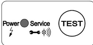
Die Wartungsmeldung zeigt sich durch Blinken der Betriebsspannungs-LED „Power“.
