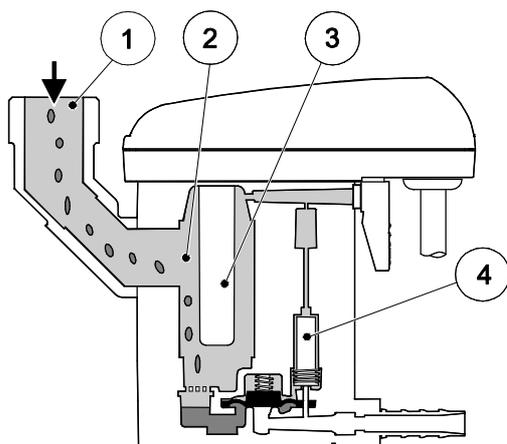
Das Kondensat strömt über die Zulaufleitung (1) in den BEKOMAT® 31U und sammelt sich im Gehäuse (2).
