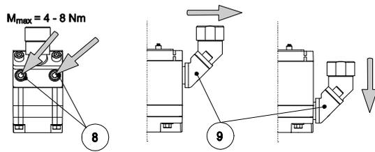
7. **oder** Schrauben (8) am Zwischenadapter (9) lösen und diesen nach unten von der Service-Unit abziehen
