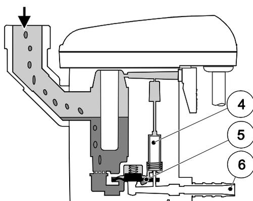
Das Vorsteuerventil (4) wird betätigt und die Membrane (5) öffnet zur Kondensatausschlebung die Ablaufleitung (6).
