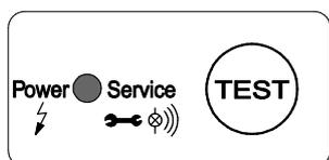
Beim Anlegen der Versorgungsspannung führt der BEKOMAT 31U einen **Selbsttest** durch.
