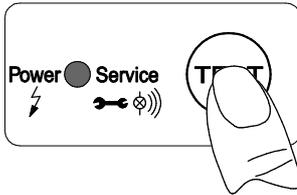
Vor dem Tausch der Service-Unit ist ein Reset durchzuführen. Die Steuereinheit ist durch Betätigen des Rasthakens zu lösen. Im abgenommenen Zustand ist der TEST-Taster mindestens 5 Sekunden zu betätigen.
