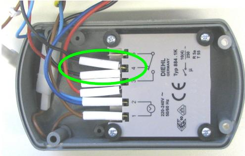
12. Das braune Kabel an der mit der Nr. 5 gekennzeichneten Stelle anschließen.
