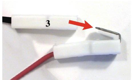
5. Das rote und schwarze Kabel an der mit der Nr. 3 gekennzeichneten Stelle anschließen.
