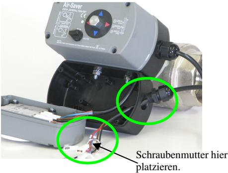
4. Das rote Kabel der Fernbedienung mit dem schwarze Kabel von Punkt 3 verbinden.
