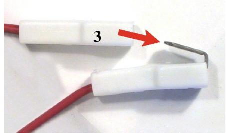
7. Das rote Kabel an der mit der Nr. 3 gekennzeichneten Stelle anschließen.
