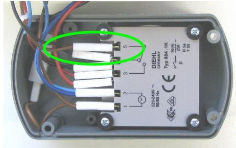
13. Sicherstellen dass die Kabel ordnungsgemäß angeschlossen sind.
