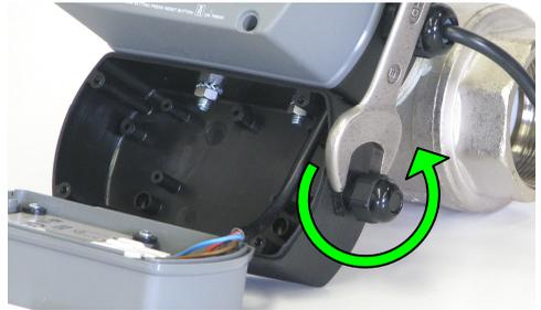
3. Kabel mit Durchführung montieren.
