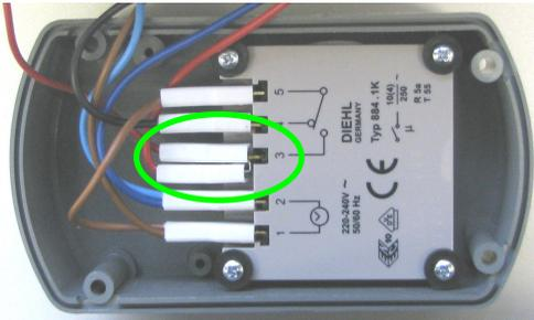
8. Das blaue Kabel der Fernbedienung mit dem braunen Kabel von Punkt 5 verbinden.
