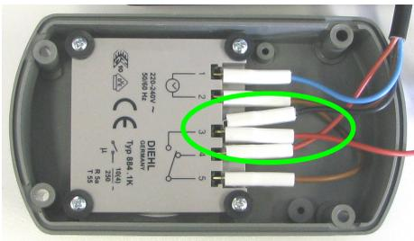
6. Das blaue Kabel der Fernbedienung mit dem braunen Kabel von Punkt 5 verbinden.
