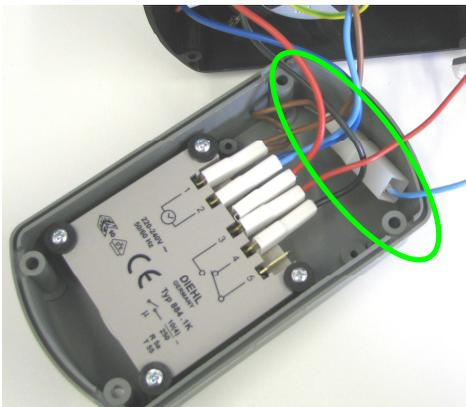
10. Das schwarze Kabel der Fernbedienung mit dem schwarzen Kabel von Punkt 4 verbinden.
