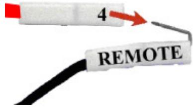
9. Das schwarze und rote Kabel an der mit der Nr. 4 gekennzeichneten Stelle anschließen.
