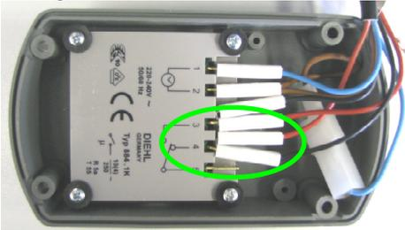
10. Das braune Kabel an der mit der Nr. 5 gekennzeichneten Stelle anschließen.
