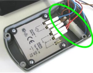
8. Das schwarze Kabel der Fernbedienung mit dem rote Kabel von Punkt 4 verbinden.
