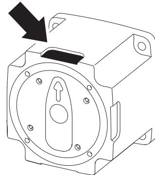
Recuerde sus ajustes de par poniendo sus propias marcas en las cuatro áreas de la carcasa.
