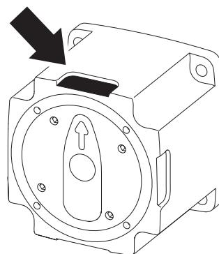
Чтобы запомнить собственные регулировки крутящего момента, отметьте на корпусе соответствующее положение регуляторов.
