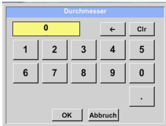
Hier kann der **Innendurchmesser** des Durchflussrohrs eingetragen werden, falls dieser nicht automatisch korrekt eingestellt wurde.
