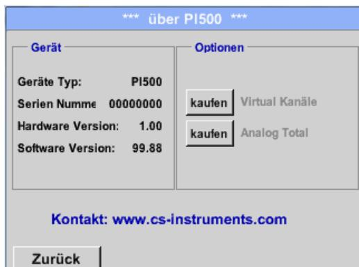
Durch Drücken des **Kaufen** Knopfes für „Virtual Channels“ werden Sie zur Eingabe des Freischaltcodes aufgefordert.
