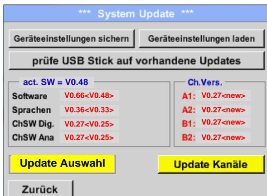
Ist das PI 500 korrekt mit dem USB-Stick verbunden, und neuere Version wurden gefunden werden diese angezeigt.
