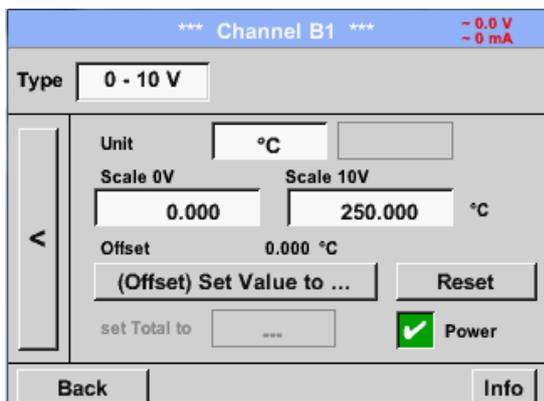
Mit dem *Setze-Wert-auf*-Knopf (*Offset*) können die Messdaten des Sensors auf einen bestimmten Wert gesetzt werden. Die positive oder negative Differenz des *Offsets* wird angezeigt.
