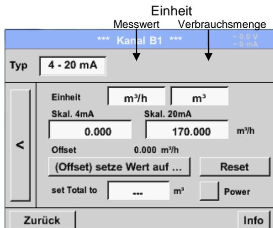
Auswahl der Einheiten durch drücken auf die entsprechenden Textfelder Einheit **Messwert** bzw. **Verbrauchsmenge**
