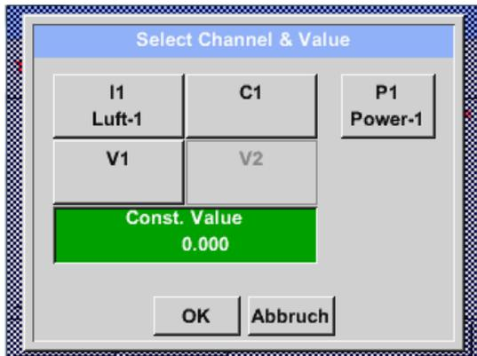
Durch drücken eines Hardware oder virtuellen Kanal Knopfes z.B. *I1* öffnet sich eine Auswahlliste mit den pro Kanal verfügbaren Messkanälen bzw. Messwerten incl. definierten virtuellen Kanälen.
