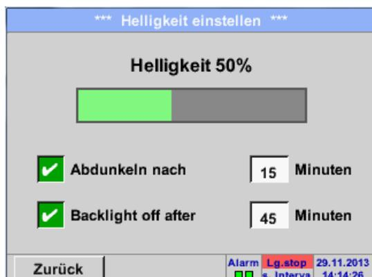
Mit Hilfe des **Abdunkeln-nach**-Knopfes kann, nach Ablauf eines zu definierenden Zeitintervalls (hier nach 15 Minuten), die **Helligkeit** auf das Minimum herabgesetzt bzw. komplett ausgeschaltet werden. Zusätzlich kann, um die Batterie zu schonen, das Displayhinterleuchtung mittels **Backlight off after** Knopfes nach dem definierten Zeitintervall (hier 45 Minuten) komplett abgeschaltet werden.
