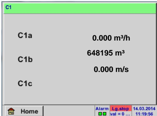
Die Ansicht *Kanäle* zeigt die aktuellen Messwerte des angeschlossenen Sensors. Bei Über- bzw. Unterschreitung der eingestellten Alarmgrenzen blinkt der jeweilige Messwert gelb (*Alarm-1*) bzw. rot (*Alarm-2*).
