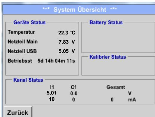
Der Menüpunkt *System-Übersicht* bietet Information über, die anliegenden Spannungen und Ströme der einzelnen und der gesamten *Kanäle*, sowie die Spannungsversorgung der *Netzteile an*.
