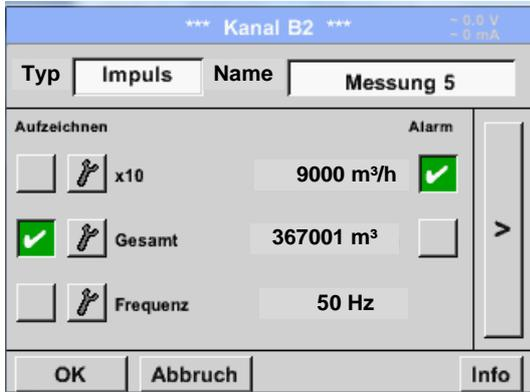
Normalerweise steht der Zahlenwert mit Einheit für **1 Impuls** auf dem Sensor und kann diesen direkt ins **1 Impuls =** Textfeld eingetragen.
