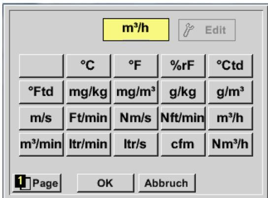
Die Auswahl der Einheit erfolgt durch drücken des gewünschten Einheiten-Knopfes. Die Übernahme der Einheit erfolgt durch betätigen des Knopf *OK*.
