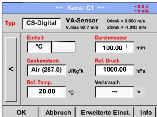
Die rot beschrifteten Textfelder zeigen an, dass verschiedene Werte wie z. B. der *Durchmesser* und der *Name* geändert oder hinzugefügt wurden.
