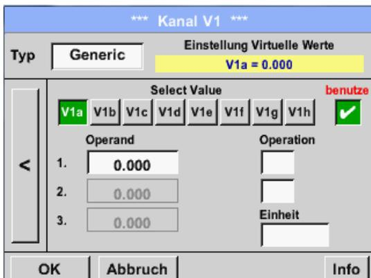
Aktivierung eines virtuellen Wertes erfolgt durch betätigen des jeweiligen *Werte-Knopfes* z.B. *V1a* mit anschließender Betätigung des *Use-Knopfes*
