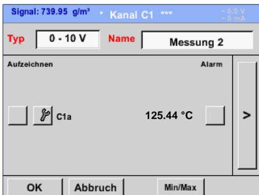
Die Skalierung des Sensors (hier zum Beispiel *Typ 0 – 10 V*) entspricht 0 – 250 °C) entnehmen Sie bitte dem Datenblatt ihres angeschlossenen Sensors.
