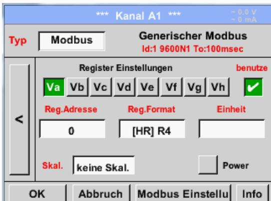
Via Modbus können bis zu 8 Registerwerte (aus Input oder Holding Registern) des Sensors ausgelesen werden.
