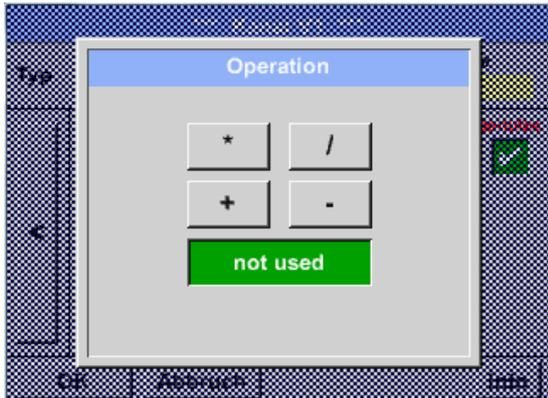
Durch drücken auf das Textfeld *1st Operation* gelangen Sie in eine Liste mit den verfügbaren mathematischen Operatoren
