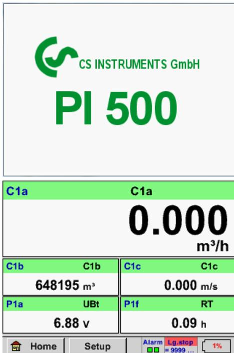
Nach dem Einschalten des PI 500 erfolgt die Initialisierung des Kanals und das Menü „*Aktuelle Werte*“ erscheint.
