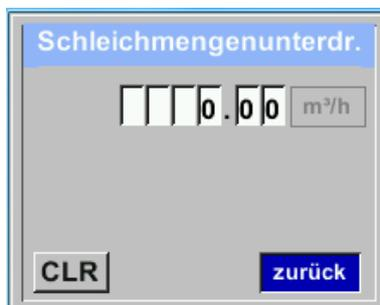
Die Schleichmengenunterdrückung kommt in Anwendung um Verbrauchswerte unterhalb des definierten „LowFlow Cut off“ Wertes als 0 m³/h anzuzeigen und auch nicht zum Verbrauchszählerstand zu addieren.
