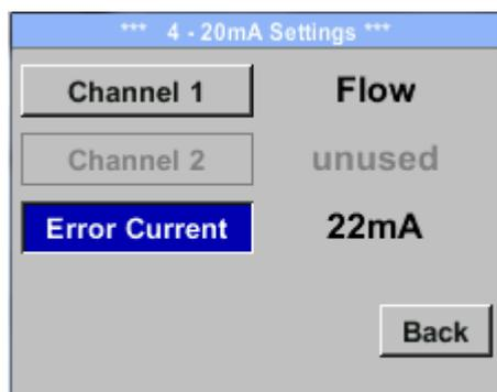
Hiermit wird festgelegt was im Fehlerfall am Analogausgang ausgegeben wird.
