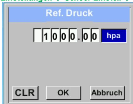
Um Änderungen, z.B. der Einheit, vorzunehmen, muss mittels Taste „>“ das Tastenfeld „Einheit“ angewählt werden und anschließend mit Taste „OK“ auswählen. Gewünschte Einheit mit Taste „>“ auswählen und 2x mit Taste „OK“ bestätigen / übernehmen.
