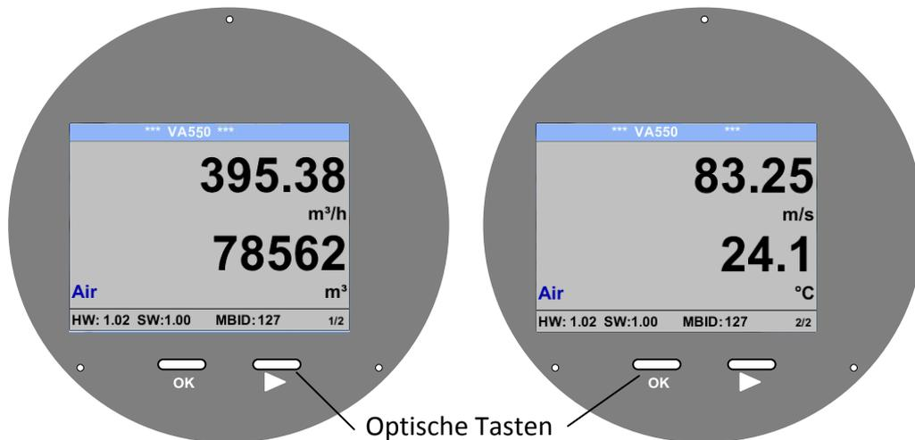
Die Auswahl der einzelnen Menüpunkte erfolgt durch die Taste „>“ und Bestätigung durch Taste „OK“
