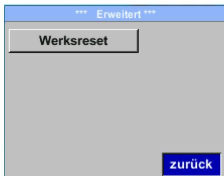
Mit Taste „Werksreset“ kann man den Sensor auf die Werkseinstellungen zurücksetzen.
