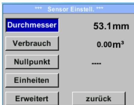
Um Änderungen vorzunehmen, zuerst einen Menüpunkt mit Taste „ $\Delta$ “ anwählen und anschließend mit Taste „OK“ auswählen
