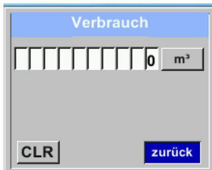
Um Änderungen, z.B. der Einheit, vorzunehmen, muss mittels Taste „>“ das Tastenfeld „Einheit“ angewählt werden und anschließend mit Taste „OK“ auswählen. Gewünschte Einheit mit Taste „>“ auswählen und 2x mit Taste „OK“ bestätigen / übernehmen.
