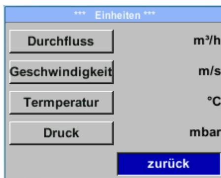
Um Änderungen der Einheit für den jeweiligen Messwert vorzunehmen muss mittels Taste „>“ das Tastenfeld des Messwertes angewählt werden und mit Taste „OK“ aktiviert werden.
