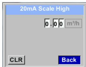
Die Skalierung des 4-20mA kann automatisch mit „Auto Skalierung = ein“ oder manuell „Auto Skalierung = aus“ erfolgen.
