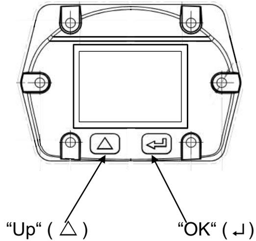
Die Bedienung des VA 520 erfolgt über die beiden kapazitiven Tasten Up (△) und OK (↵)
