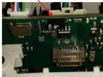
Alternativ dazu kann auch ein 120R Widerstand im Stecker zwischen Pin 2 und Pin 4 verbaut werden. Beim Zusammenbau auf korrekten Sitz der Gehäusedichtung achten, siehe auch Pkt. 4.5.
