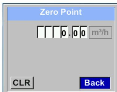
Zeigt der Sensor im eingebauten Zustand ohne Durchfluß bereits einen Durchflußwert von  $> 0$  m<sup>3</sup>/h kann man hier den Nullpunkt der Kennlinie setzen.
