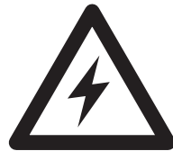
Achtung: Gefahr durch elektrische Spannung
