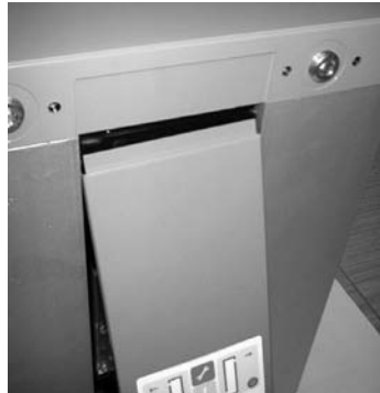
5. Vorderwand wieder einsetzen, dazu die Feder in die Nut stecken und die Abdeckung nach oben innen drücken.
