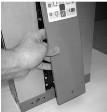
3. Vordere Abdeckung zur Entfernung nach außen und unten kippen.
