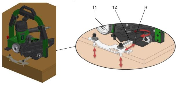
Für einen Betrieb mit dem verbauten Parallelanschlag (12) an einer Plattenkante oder mit Hilfe der Visiereinrichtung (19) an einer vorgegebenen Linie gehen Sie wie folgt vor:
