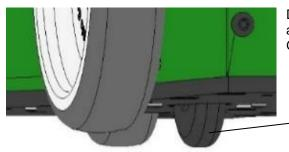
Der Slider ist mit einer Sicherungsrolle (17) an der Unterseite ausgerüstet, dies lässt eine Auslösung nur bei aufgesetztem Gerät zu.
