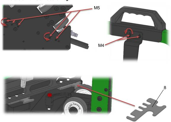
Sie können die Eintreibtiefe der Befestigungsmittel in das Material durch Einlegen oder Herausnehmen von Distanzblechen stufenweise einstellen. Es sind 6 Distanzbleche mit je 1mm Stärke im Lieferumfang. Pro eingebautes Distanzblech erhöht sich der Mündungsabstand zum Material um 1mm.
