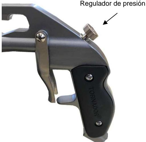
Para desarrollar una potencia óptima, la TORNADOR® Foam necesita una presión de aire constante de entre **6 y 9,2 bar**,
