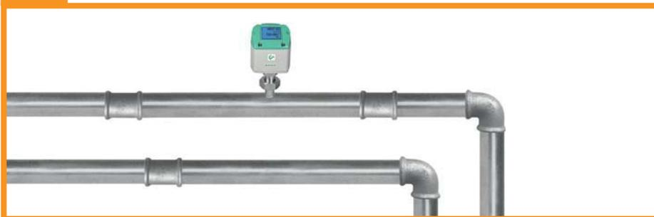
Für den stationären Einsatz stehen folgende Ausgänge zur Weiterleitung an die Gebäudeleittechnik oder SPS zur Verfügung: 4...20 mA für den Momentanverbrauch. Impulsausgang (galvanisch isoliert) für den Gesamtverbrauch.
