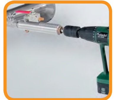
Anbohren unter Druck mit der CS Bohrvorrichtung Bestell-Nr.: 0530 1108
